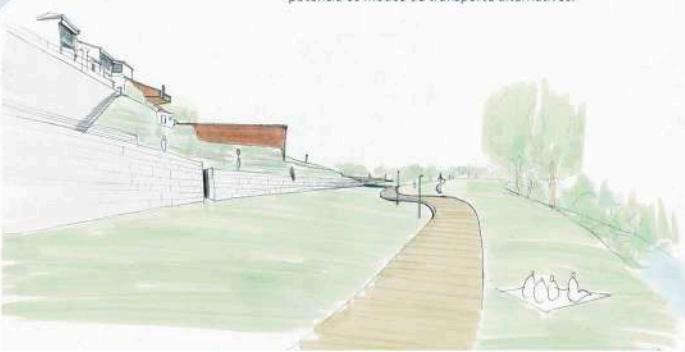
A conexión dende o casco histórico parte do mirador da praza da estrela, arrancando cun elevador que conecta co primeiro desembarco das escadas co fin de acadar a cota do muro intermedio da muralla. Dende aquí se disporá una rampa apoiada no terreo que xerará unha senda sobre o espazo vacante entre os muros desta, actuando a vez de mirador e desembocando na senda fluvial. O percorso se achega a un antigo baluarte o cal é enfatizado mediante unha peza que replique a súa estrutura.
